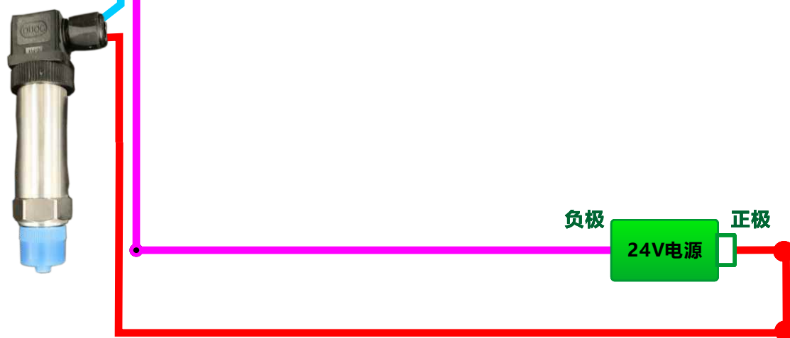
4-20mA两线制压力传感器接线图
