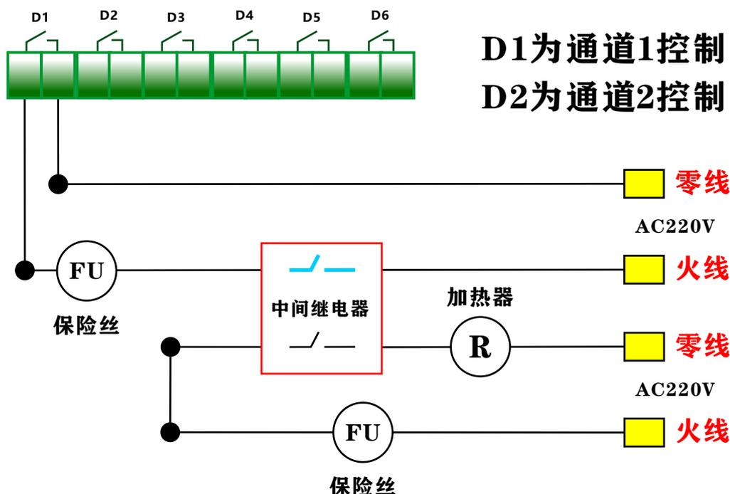
当仪表安装控制模块时,仪表具备控制输出功能,可控制交流接触器,固态继电器,可控制调压器等.仪表D1-D24分别对应通道1-24通道控制输出.根据不同输出,不连接不同的负载.
