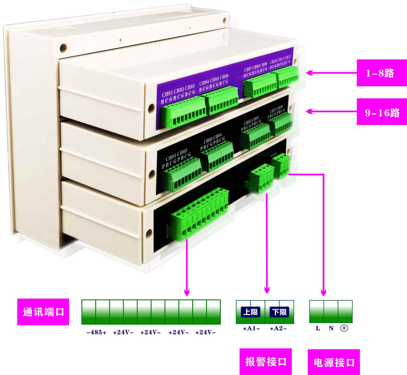
仪器每个信号输入端增加1个配电接口，不用另外飞线
