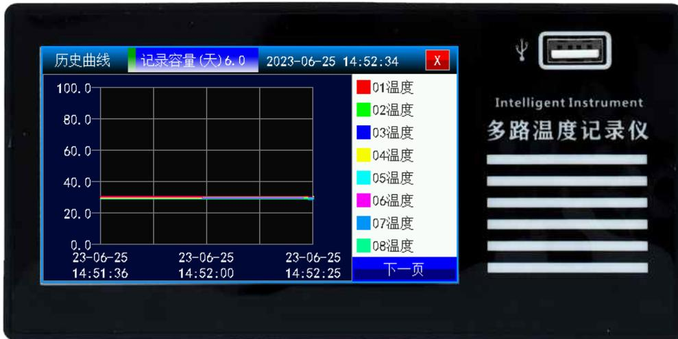
历史曲线与实时曲线基本相同，不同的时历史曲线与曲线间隔无关，直接输入开始时间与结束时间查询，无论是历史曲线还是实时曲线，坐标都是通过系统设置的坐标上限与坐标下限来实现的，曲线在显示开关量时，将接通状态的值显示为100，断开状态的值定义为0,主要是为了开曲线时更直观，方便产生感观更强的方波曲线图，通道有开关量输入时,在设置曲线坐标时，应当使坐标上限设置大于100以上。
