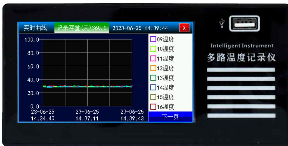
通道选择显示当前所有的可用的通道,如果当前通道被选中,以实心填充并显示当前通道的曲线,如果方框没有被填充,则不显示当前曲线.实时曲线从上电开始显示,能显示的曲线的点数取决于系统参数中的曲线间隔。整个曲线的时间长度 = 400X曲线间隔,曲线的点数为400个点,如果为1秒更新1次,那么整个曲线可显示400秒的数据。如果曲线间隔200,那么整个曲线将显示8万秒的数据,约等于22小时,最大可为33小时实时数据。
