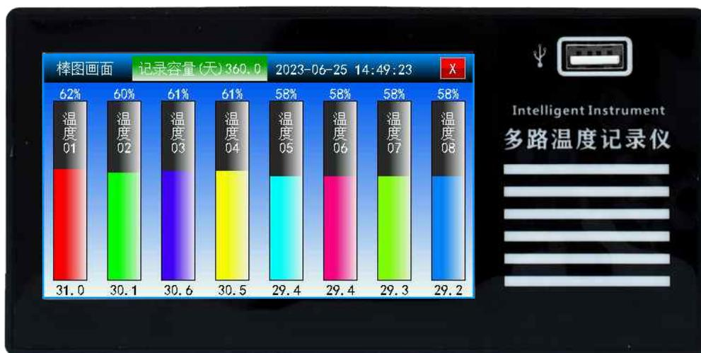
量程上限与量程下限定义了棒图的最大值与最小值，对于所有信号，当测量值大于量程上限时，显示为100%，当测量值小于量程下限时，显示为0%，对于4-20mA或0-10V等变送信号，量程上下限同时也是对应传感器量程的对应值。详见输入设置里量程上限与量程下限的设置介绍。
