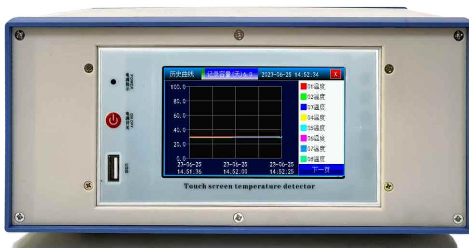
通道选择显示当前所有的可用的通道,如果当前通道被选中,以实心填充并显示当前通道的曲线,如果方框没有被填充,则不显示当前曲线.实时曲线从上电开始显示,能显示的曲线的点数取决于系统参数中的曲线间隔。整个曲线的时间长度 = 400X曲线间隔,曲线的点数为400个点,如果为1秒更新1次,那么整个曲线可显示400秒的数据。如果曲线间隔200,那么整个曲线将显示8万秒的数据,约等于22小时,最大可为33小时实时数据。
